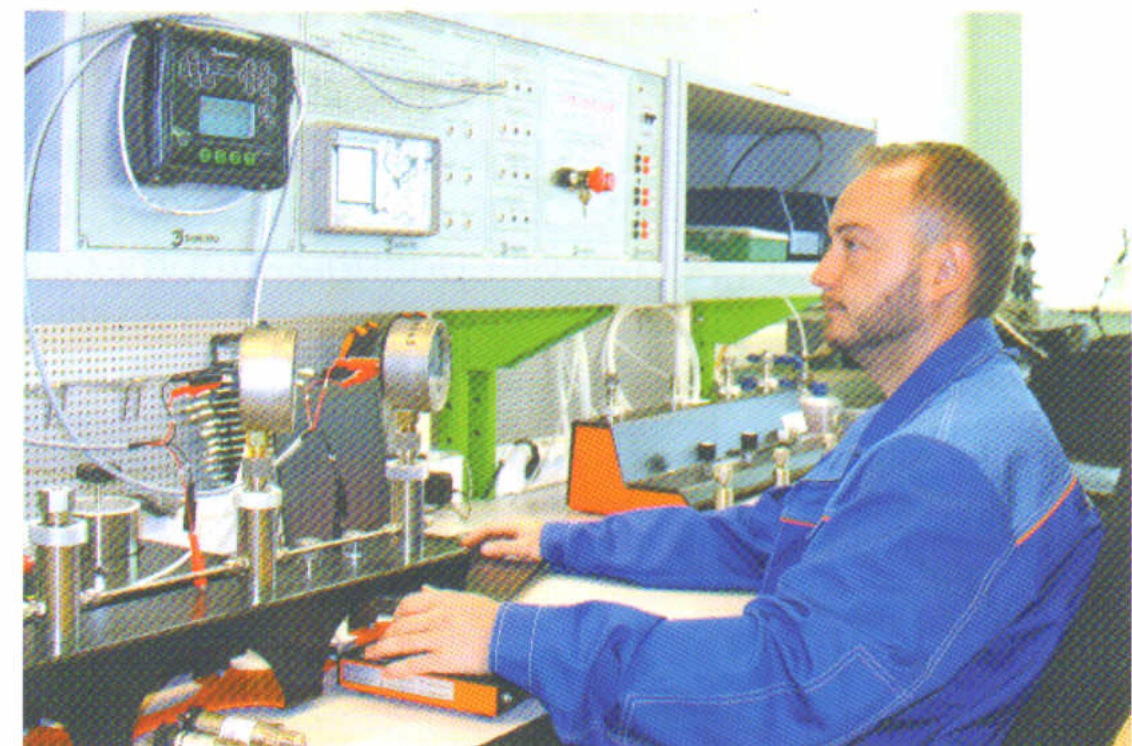
Слесарь контрольно-измерительных приборов и автоматики Александр Филиппов проводит поверку сигнализирующих манометров с токовым выходом с помощью эталонов на стенде для поверки, калибровки и ремонта средств измерений давления ЭлМетро-СПД
