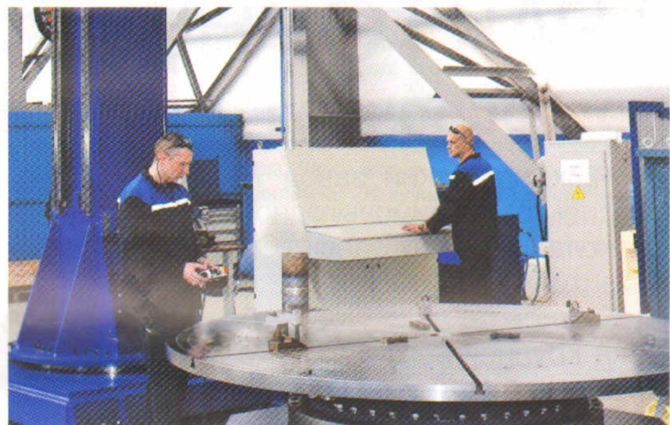
Электрогазосварщик Александр Цыганов и электрогазосварщик Николай Барышников (цех № 150) работают с установкой вертикальной наплавки
