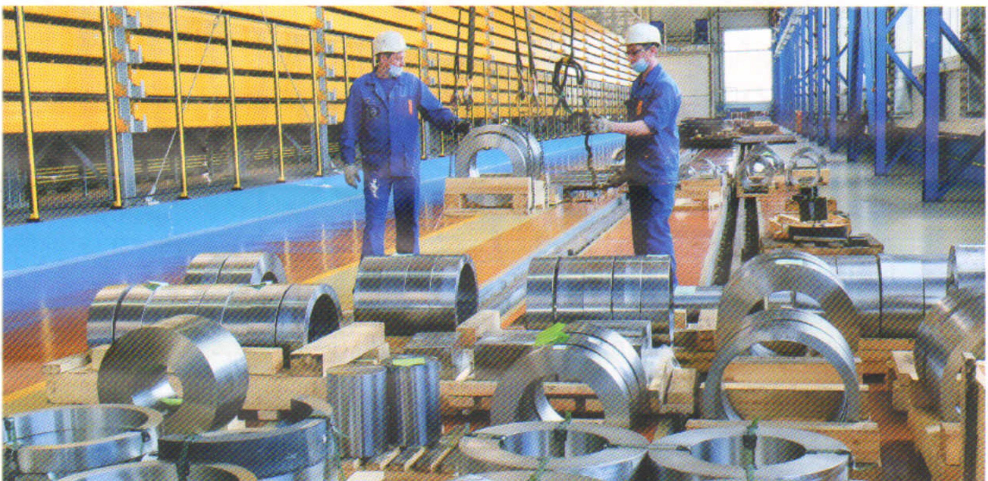
Стропальщики участка металлокомплектации Евгений Сайфеев и Сергей Бурлаков разгружают поковки, предназначенные для изготовления изделий нефтегазовой отрасли
