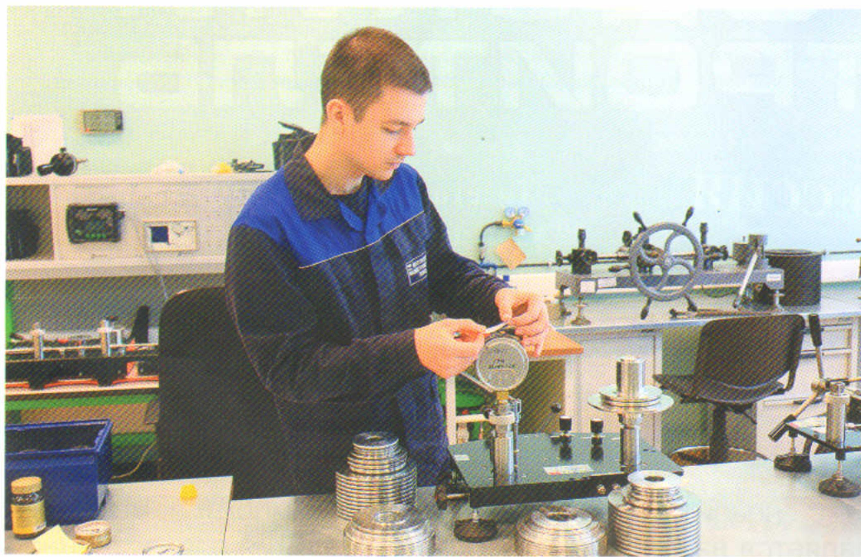
Слесарь контрольно-измерительных приборов и автоматики Владимир Крапивенко подтверждает прохождение поверки грузопоршневого газового манометра нанесением этикетки с помощью печати из электронной базы данных
