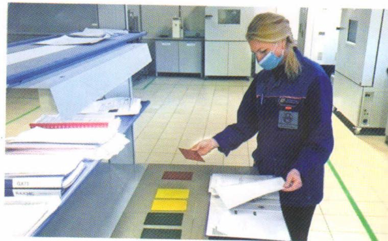
Инженер-лаборант Ирина Краснова определяет защитные и декоративные свойства лакокрасочных покрытий после проведения ускоренных климатических испытаний
