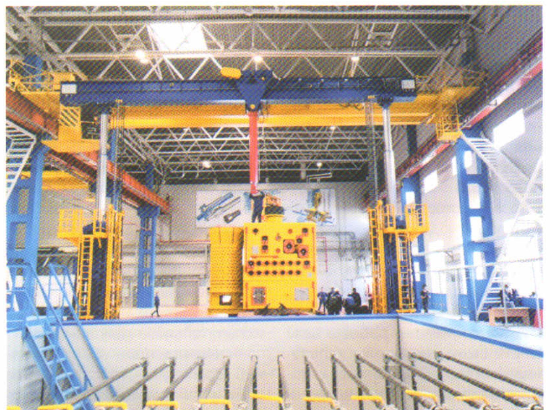
Закрепление образца подводной фонтанной арматуры на порталном подъемнике для погружения в испытательную среду для проведения тестирования
