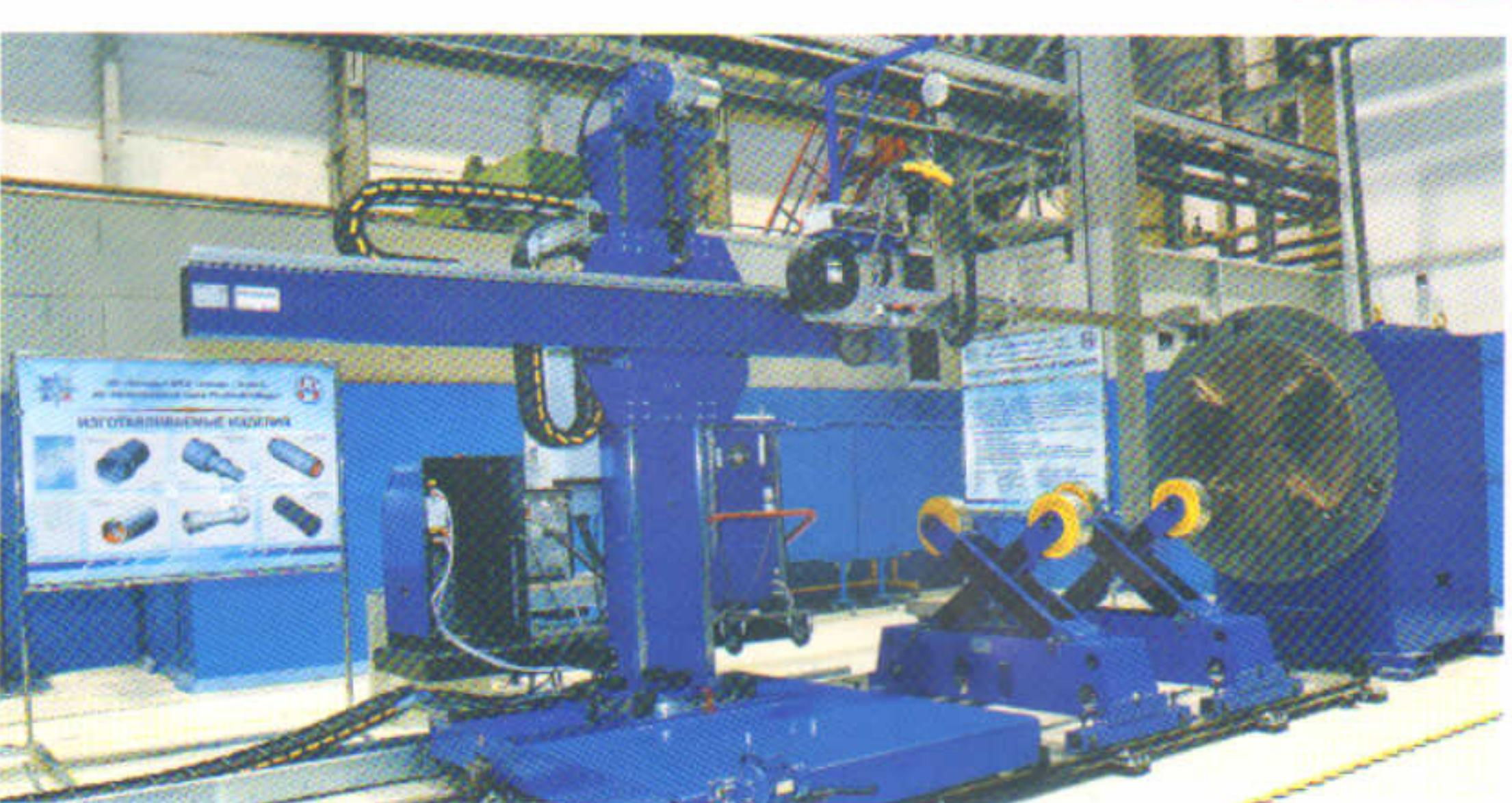
Установка горизонтальной наплавки
