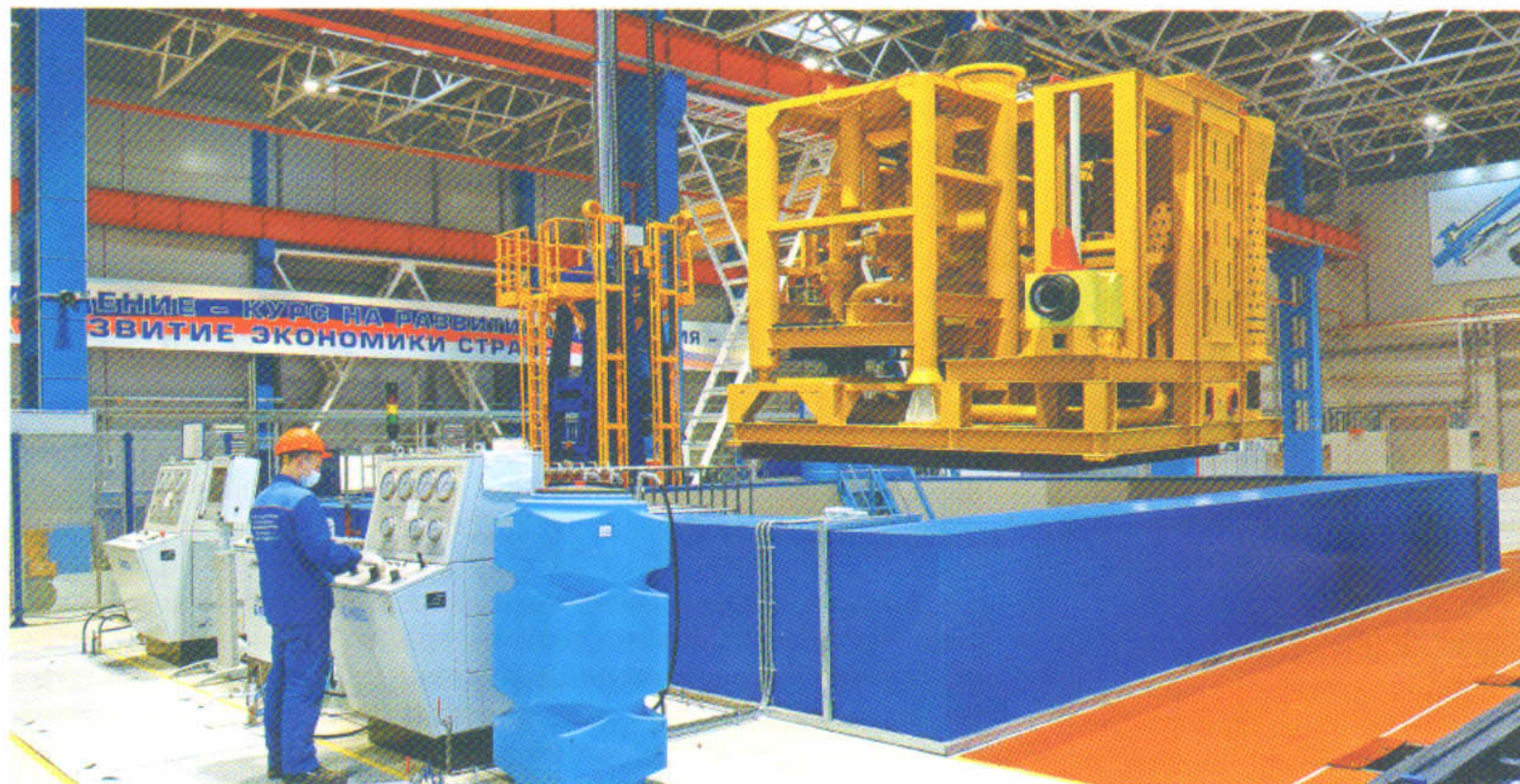
Проведение испытаний подводной фонтанной арматуры
