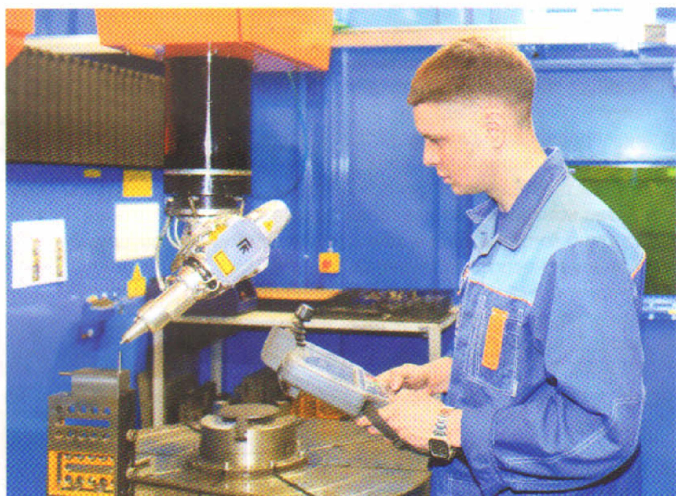
на середине толщины листа и при обработке автоматически повторяет контур детали, не отклоняясь от программы и не нарушая оснастку.
